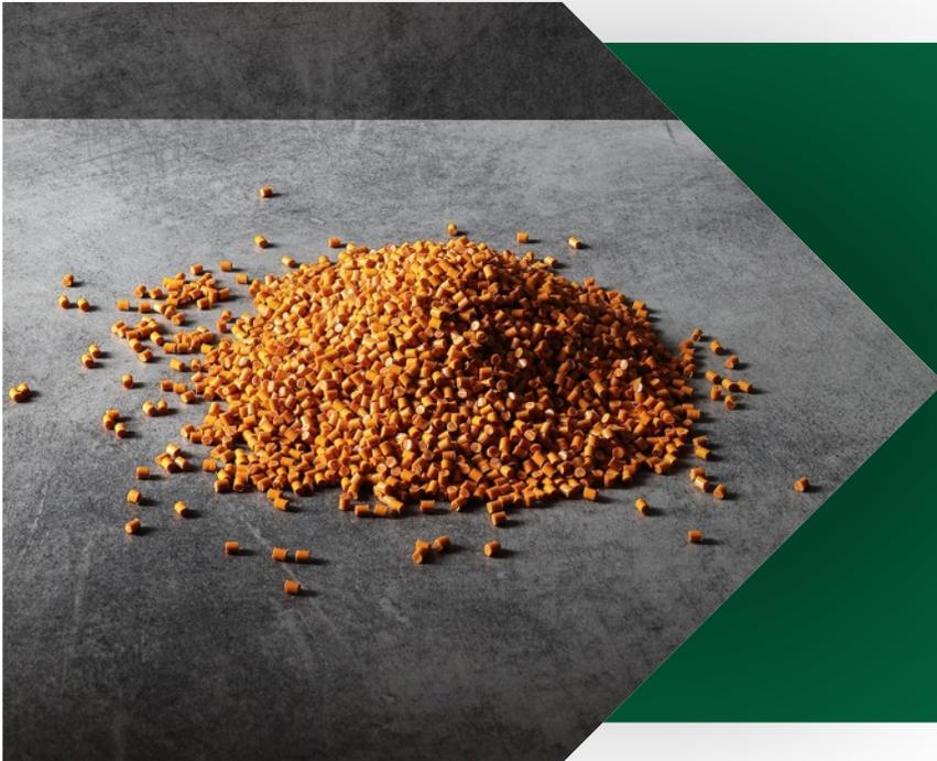
Il polipropilene viene tinto in massa immettendo nel polimero, durante la fase di estrusione, pigmenti che sono allo stato solido e che non sono assolutamente solubili in acqua e nei principali solventi. Pertanto non è necessario ricorrere alle tintorie di cui devono invece servirsi i processi produttivi di tutte le altre fibre che siano tinte in filo, in pezza o in capo: questo consente di non aver assolutamente acque di scarto colorate.
